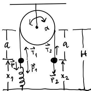
e  $\alpha = \ddot{\theta} = \frac{\ddot{x}_1}{R} = -\frac{\ddot{x}_2}{R} \Rightarrow$  (sottraendo)  $\Rightarrow (m_1 + m_2) \ddot{x}_1 = T_1 - T_2 + (m_2 - m_1)g - k(x_1 - l_0)$
