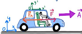
Si utilizzano due sistemi di riferimento:  $Oxy$  solido alla strada (inertiale) e  $O'x'y'$  solido all'automobile (e al guidatore), dunque accelerato con accelerazione  $\vec{A}$  costante pari all'accelerazione dell'automobile.
