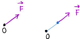
Si introduce il «potere rotazionale» della forza applicata in un punto P rispetto a un dato polo O considerando una distanza non nulla fra P e O e un'orientazione «efficace» della forza ai fini del suo intento rotazionale.
