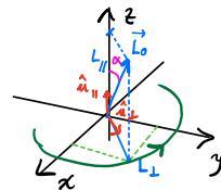
► È necessario un momento risultante esterno  $\vec{\tau}_o^{(ext)} = L_{\perp} \frac{d\hat{u}_{\perp}}{dt}$  per mantenere in rotazione il sistema (è un caso di rotazione attorno a un asse NON LIBERO)
