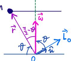
► Il versore di  $\vec{L}_o$ ,  $\hat{u}$ , non è costante, ruota con velocità angolare  $\omega$  attorno a  $z$ .
