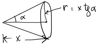
a. Nella trasformazione adiabatica  $TV^{\gamma-1}$  = costante  $\Rightarrow \left(\frac{V_1}{V_2}\right)^{\gamma-1} = \frac{T_2}{T_1}$ ,  $\frac{V_1}{V_2} = \left(\frac{x_1}{x_2}\right)^3$
