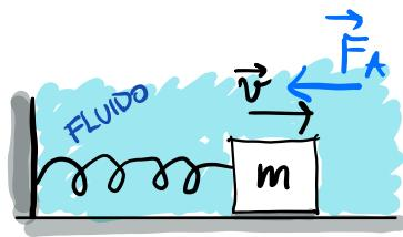
$$m\ddot{x} = -kx - b\dot{x} \quad \begin{matrix} \text{termine viscoso di la Stokes} \\ \uparrow \quad \text{si è posto } x_0 = 0 \quad \text{(l'impulso a riposo} \\ \text{della molla nulla)} \end{matrix}$$
