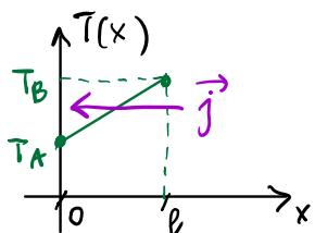
Se  $T_A < T_B$  il flusso è nel verso decrescente delle  $x$  e all'interno della lamina la temperatura cresce linearmente.
