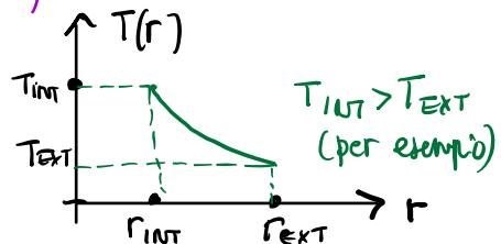
Il flusso è dato da  $\dot{q} = -k \frac{dT}{dr} = k \left[ \frac{T_{INT} - T_{EXT}}{r_{EXT} - r_{INT}} \right] \frac{r_{EXT} r_{INT}}{r^2}$
