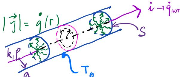
Il conduttore ha condutibilità termica costante  $k$  e resistività elettrica  $\rho$ , ovvero resistenza elettrica  $R = \rho l / S$  per un tratto di lunghezza  $l$ .
