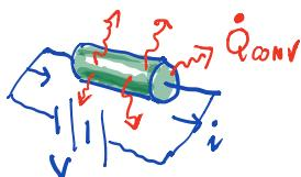
La resistenza è alimentata a 6 V e ci scorre una corrente  $i = 0.2 \text{ A}$ . La sua temperatura superficiale è  $T_s = 160^\circ\text{C}$  e quella dell'aria  $T_\infty = 20^\circ\text{C}$ . La sua area è di  $2 \times 10^{-4} \text{ m}^2$ :  $h = \frac{\dot{Q}}{S \Delta T} = \frac{V \cdot i}{S \Delta T} \sim 43 \frac{\text{W}}{\text{m}^2\text{K}}$
