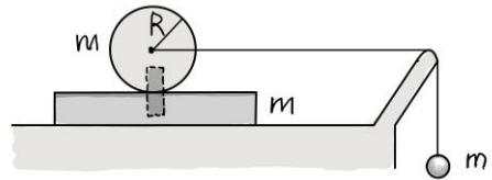
Si supponga ora che il cilindro sia collegato alla fune sul suo asse di simmetria e che non sia più rigidamente vincolato al blocco sottostante ma che possa muoversi con un moto di rotolamento puro *relativamente a esso*. In questa ipotesi, sempre a partire da una condizione iniziale di quiete e spiegando chiaramente quali coordinate vengono utilizzate:
