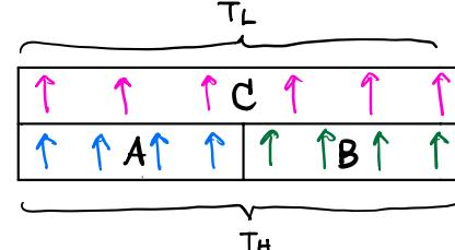
(a) Usando la legge di Fourier  $\dot{Q} = \dot{q} \cdot A = k \cdot A \frac{\Delta T}{L}$  (in modulo, area A)
