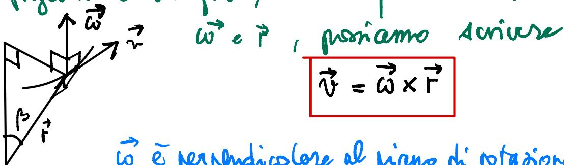
$\vec{\omega}$  è perpendicolare al piano di rotazione del punto e orientato in accordo con il verso di avanzamento della vite.
