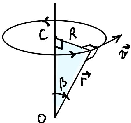
Si parte dalla definizione di velocità angolare  $v = \omega R$
