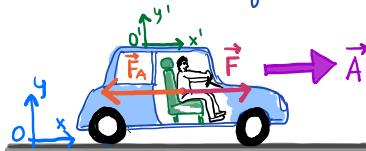
Si utilizzano due sistemi di riferimento:  $Oxy$  solido alla strada (inerziale) e  $O'x'y'$  solido all'automobile (e al guidatore) dunque accelerato con accelerazione  $\vec{A}$  costante pari all'accelerazione dell'automobile.
