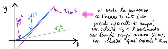
si vede la partenza «lineare» in  $t$  (per piccoli intervalli di tempo) con velocità  $v_0$  e l'andamento per lunghi tempi ancora lineare con velocità "quasi costante"  $v_{\text{lim}}$
