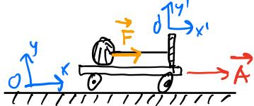
qui l'osservatore  $Oxy$  vede la massa accelerata tramite la forza  $\vec{F} = m\vec{a}$  (la tensione della corda) mentre  $O'x'y'$  vede la massa in equilibrio sotto l'azione di  $\vec{F}$  e delle forze apparente  $\vec{F}_A = -m\vec{a}$  tale che
