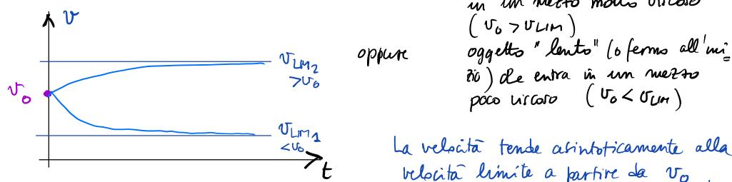
La velocità tende asintoticamente alla velocità limite a partire da  $v_0$ .
