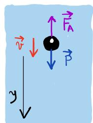
Equazione del moto per la massa di peso  $\vec{P}$  nel fluido con coefficiente di attrito  $k$ :
